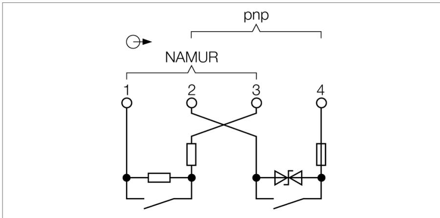
Генератор частоты фирмы Турк FG1 предназначен для моделирования датчиков NAMUR (DIN EN 60947-5-6) или нормально открытых контактов. Нормально открытый выход защищается Зенер-диодом и самовосстанавливающимся плавким предохранителем, который активируется при приближ. 200 мА.
